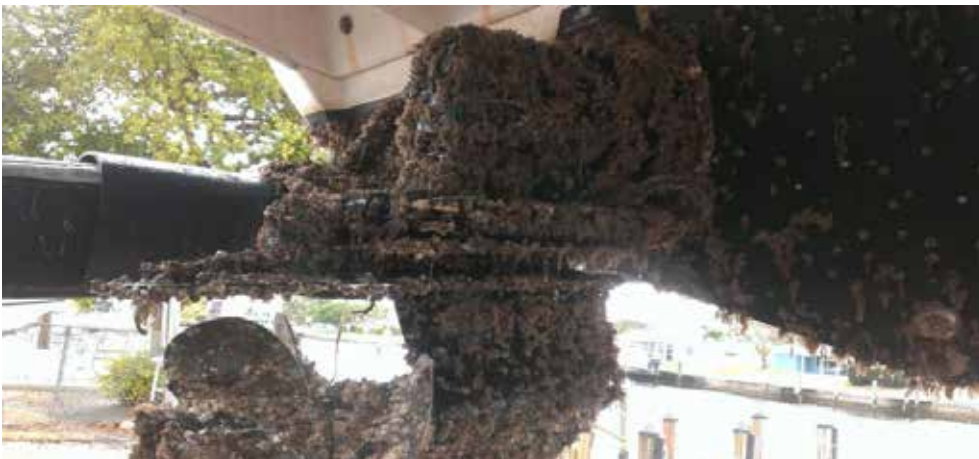
Voorbeeld van een Mercruy hekaandrijving met groei door langdurig in water zitten.
